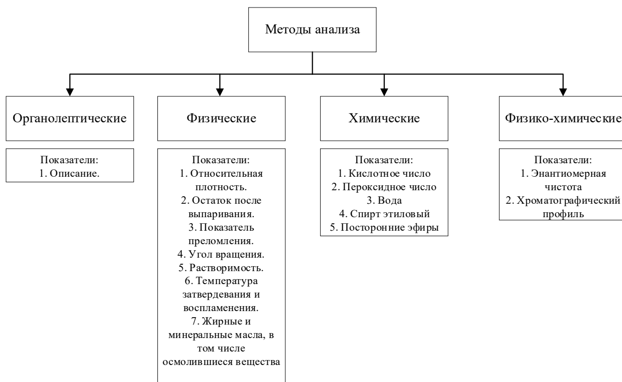
Рисунок 3 – Сводная схема методов анализа эфирных масел по основным показателям качества. Рисунок подготовлен автором
