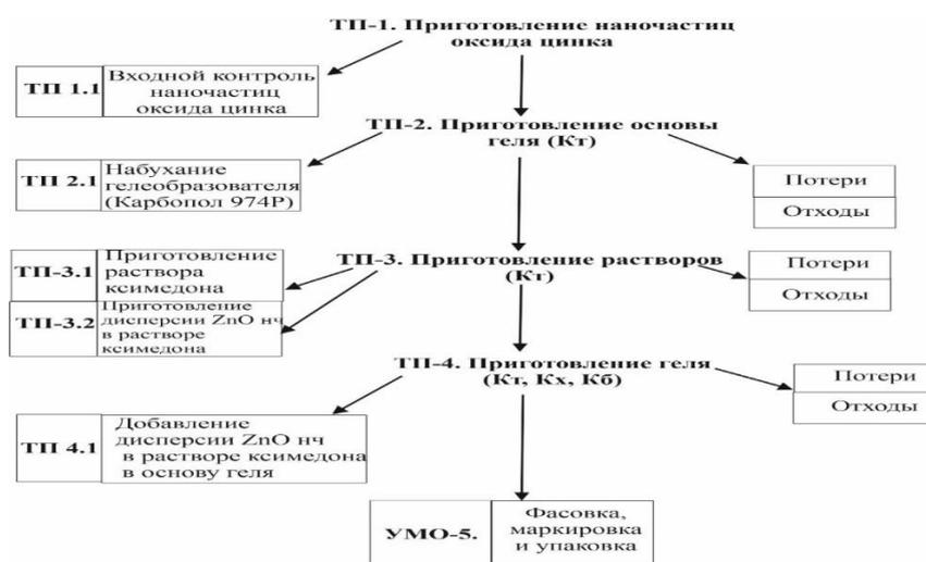
Рисунок 13. Технологическая схема производства геля ксимедона с ZnO нч
