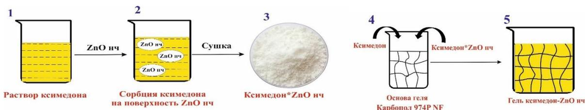
**Рисунок 10.** Схематическая иллюстрация приготовления комбинированной МЛФ ксимедона с ZnO нч
