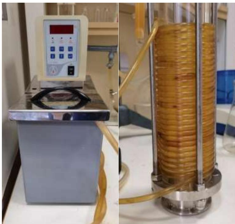
Рисунок 4.24. Модернизированная обогреваемая камера аппарата Сокслета
