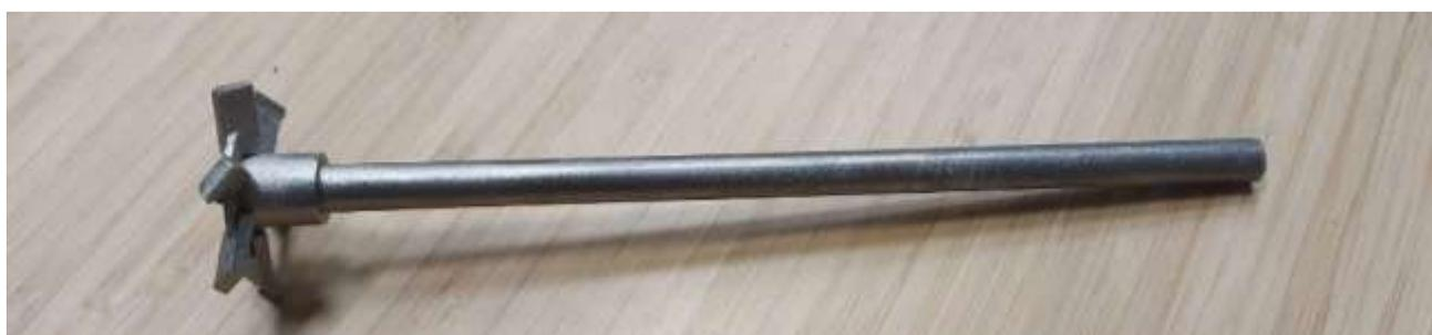
Рисунок 4.16. Изготовленная модель разработанной конструкции мешалки
