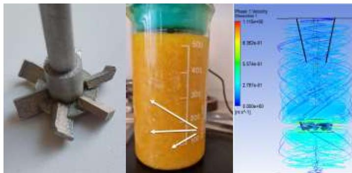
Рисунок 4.18. Модернизированный шестилопастной импеллер (направление движения частиц сырья указано стрелками)
