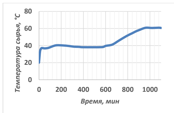
Рисунок 2. – Зависимость температуры в слое от времени сушки
