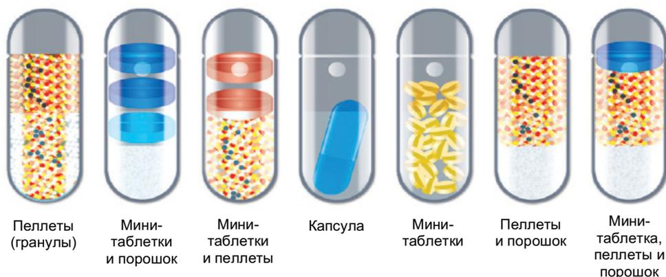
Рисунок 1.4 – Варианты наполнения полипилла мультичастицами
