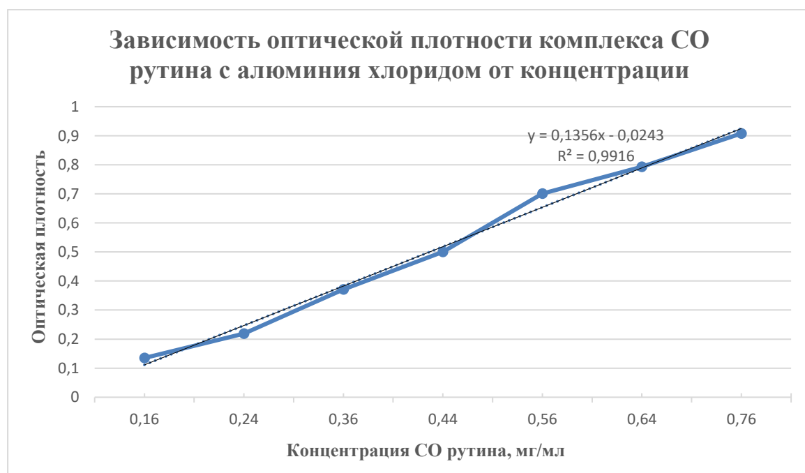
Рисунок 25 - Зависимость оптической плотности комплекса СО рутина с AlCl_3 от его концентрации
