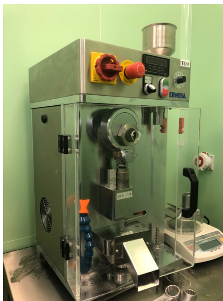
Рисунок 2.18 – Однопансионный таблеточный пресс Erweka EP-1 (Erweka, Германия)
